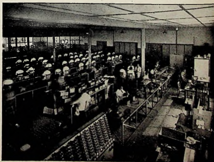
Fig. 2. De radiolampenfabriek; op den achtergrond rechts de in een schermkast staande lampzender, die hoogfrequent- stroom levert voor de pomp- installatie.
